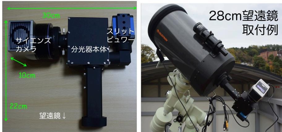
図1：光藝の全体図（左）および望遠鏡に取り付けた様子（右）
