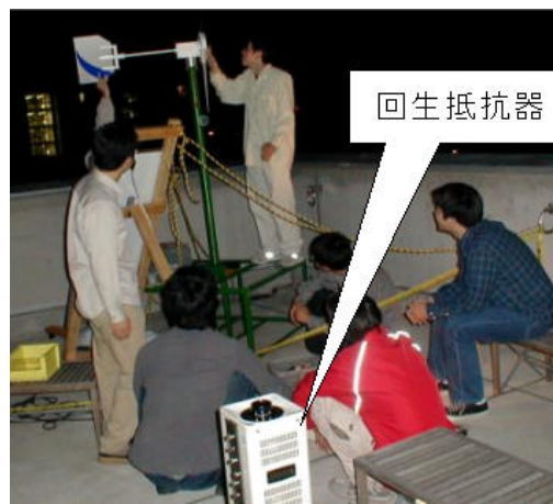
図 6.15 回生抵抗器を利用した実験
