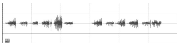
(a) 改良前。それぞれのモーラが開始から指定された秒数後に突然終わってしまう。また、音圧も一定していない。
